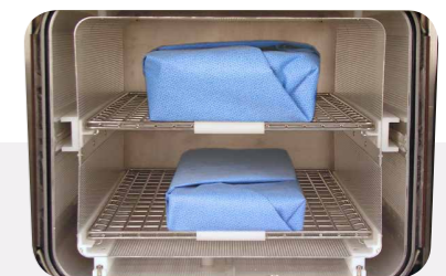
CYCLE FLEX Préparation de la charge: Un maximum de deux endoscopes souples à canal unique (poids total: 9,7 kg)
